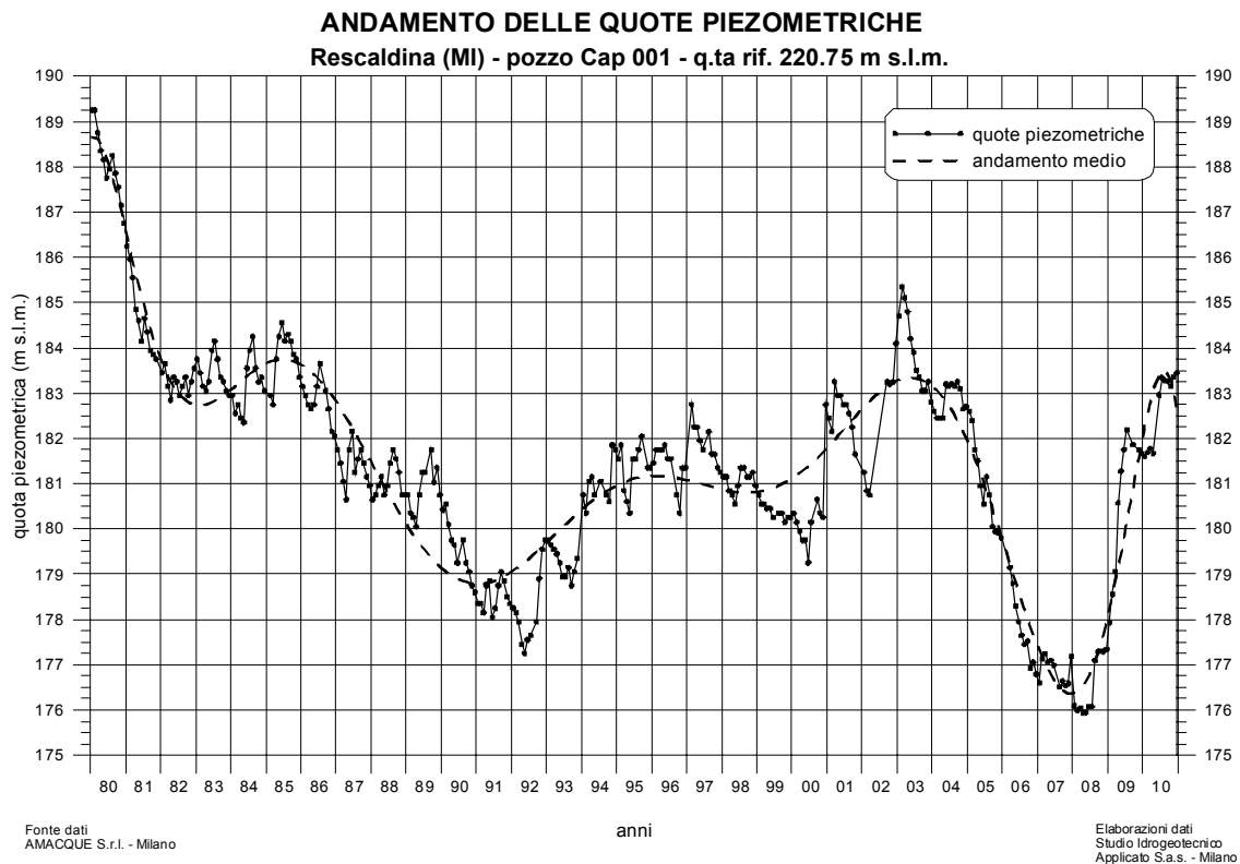
Figura 2.1 – Andamento delle quote piezometriche
