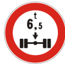
Figura II 69 Art. 118 TRANSITO VIETATO AI VEICOLI AVENTI MASSA PER ASSE SUPERIORE A .....TONNELLATE
