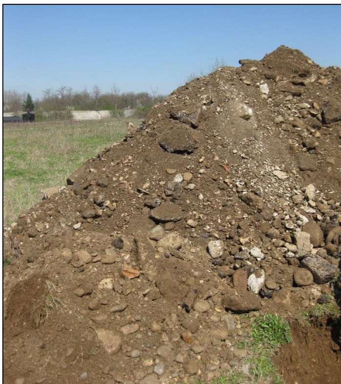
Foto 5. Materiale di riporto nella Trincea T5 – 0-3.7 metri.
