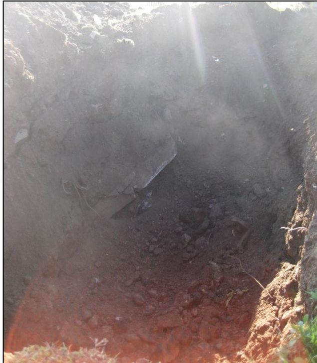
Foto 12. Materiale di riporto nella Trincea T9 – 0-3.2 metri.
