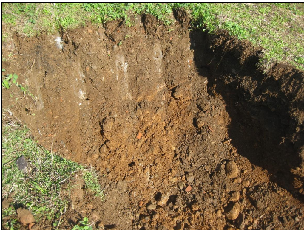
Foto 3. Materiale di riporto nella Trincea T4 - 0-0.5 metri.
