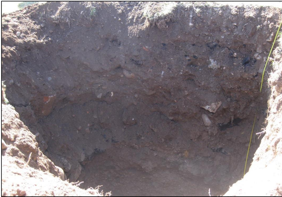
Foto 7. Materiale di riporto nella Trincea T6 – 0.5 metri.
