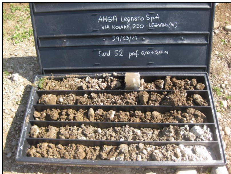
Foto 19. : Carota terreno relativo al sondaggio S2
