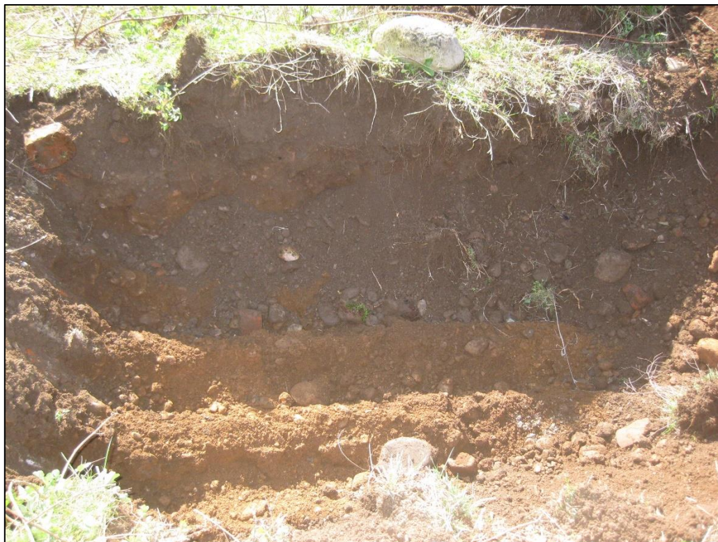
Foto 2. Materiale di riporto nella Trincea T3 – 0-0.5 metri.
