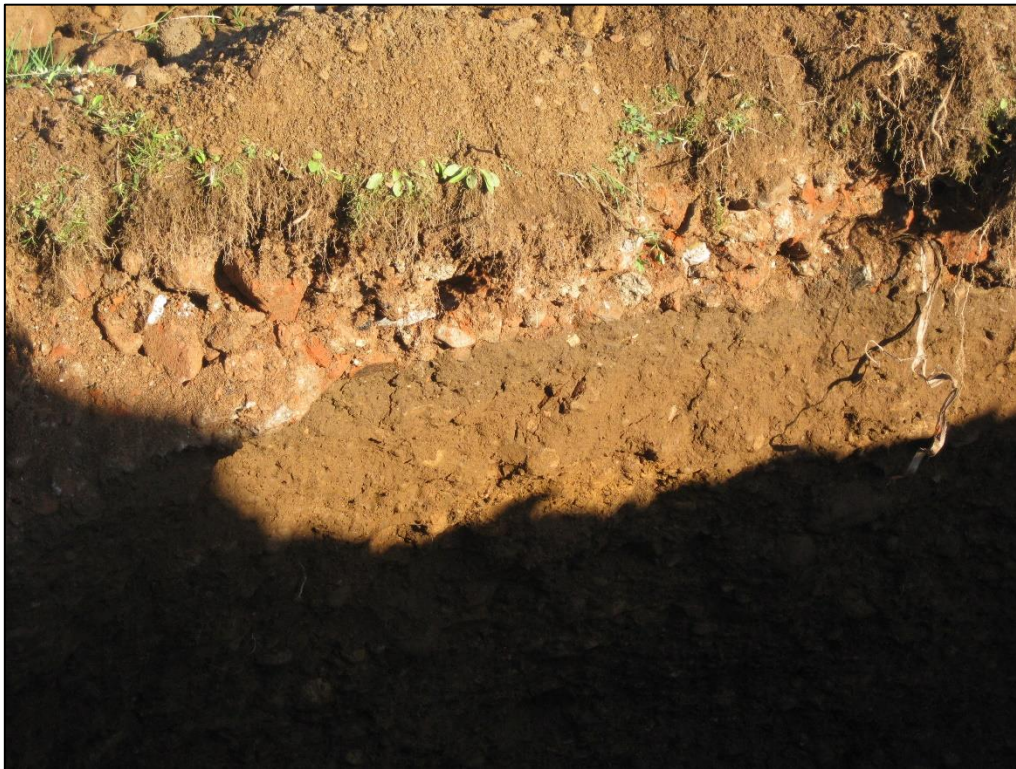
Foto 15. Materiale di riporto nella Trincea T10 – 0-3 metri con evidenza della soletta.
