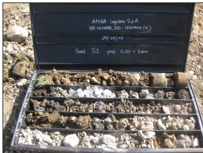
Foto 17. Carota di terreno relativo al sondaggio S1.
